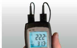
Mesures simultanées de deux températures, et affichage du delta de température
